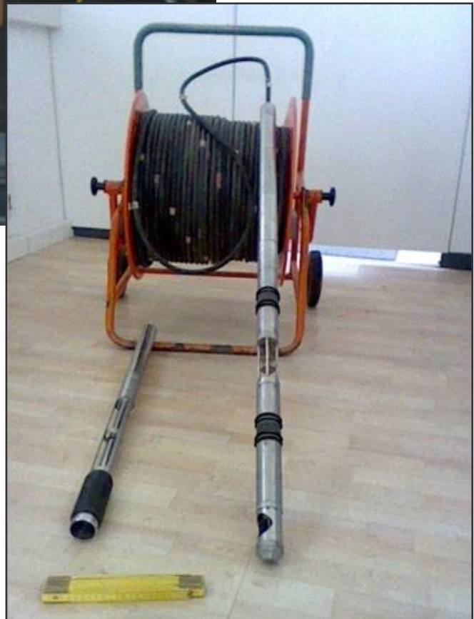
Abb. 1c: Tragekabel und Messsonden für horizontale und vertikale Fließmessungen für einen Einsatz ab 2" Durchmesser
