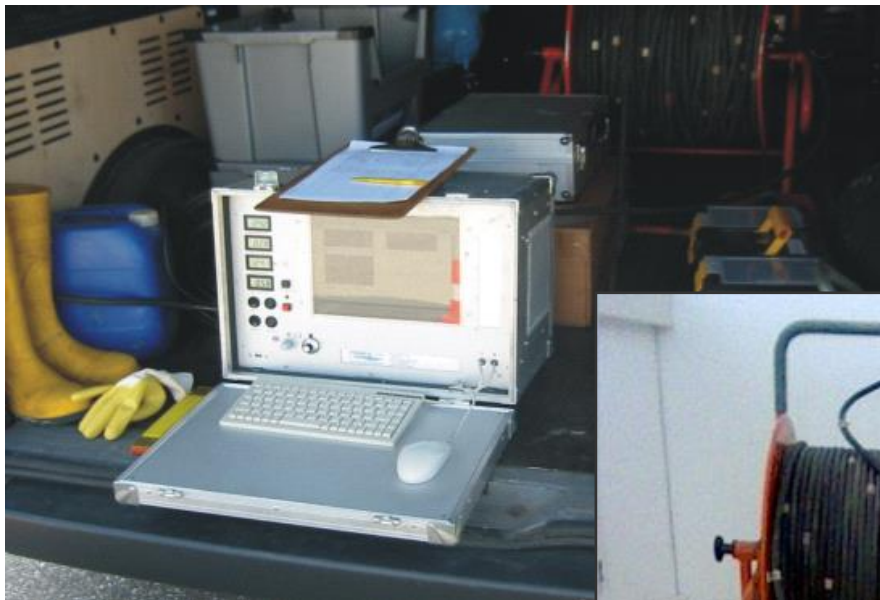
Abb. 1b: Rechneinheit zur Bedienung der Messsonden und Auswertung der Bilddaten
